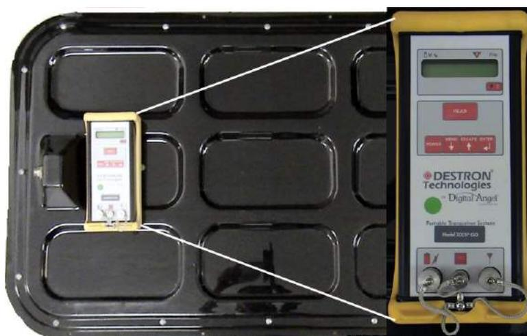
Figura 3.2: Antena e leitora FS2001-ISO utilizada neste trabalho.
