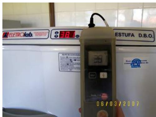
Figura 5.3: Termômetro digital e estufa B.O.D.
