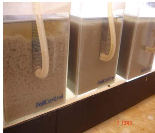
FIGURA 4.13 – Detalhe do volume de lodo gerado no jarteste.
