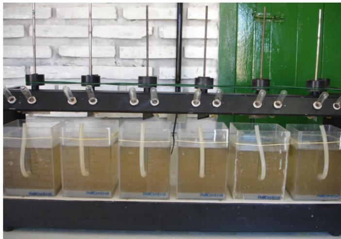
FIGURA 5.3 – Jarreste com Hidroxicloreto de Alumínio.
