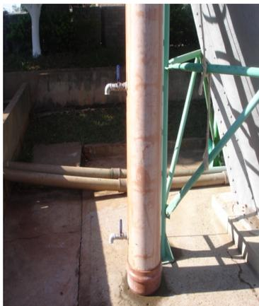
FIGURA 4.8 – Detalhes dos registros da coluna de sedimentação.
