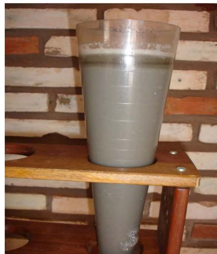
FIGURA 4.11 – Grande quantidade de sólidos sedimentáveis no efluente bruto.
