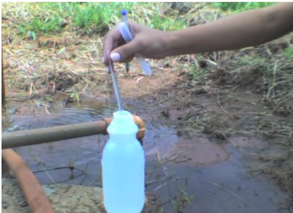
**FIGURA 4.4 - Determinação da temperatura de água subterrânea na Bacia do Ribeirão Salobra**
