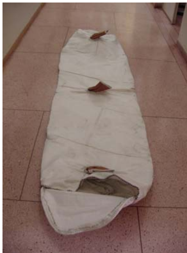
Figura 4.6. Modelo reduzido de geotubo confeccionado com manta geotêxtil.
