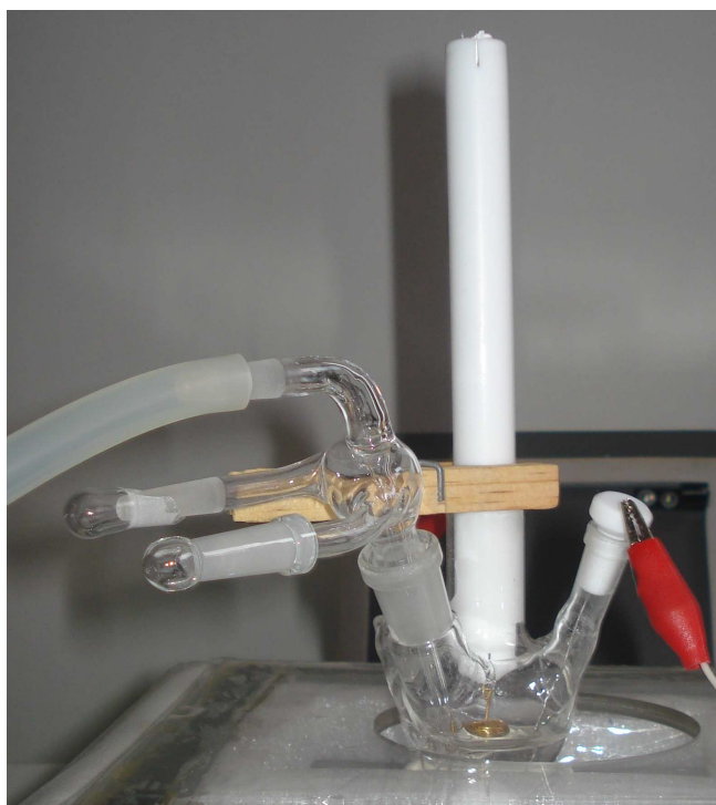
Figura 2.4: Célula espectroeletroquímica de três eletrodos para uso em experimentos de espectroscopia vibracional.
