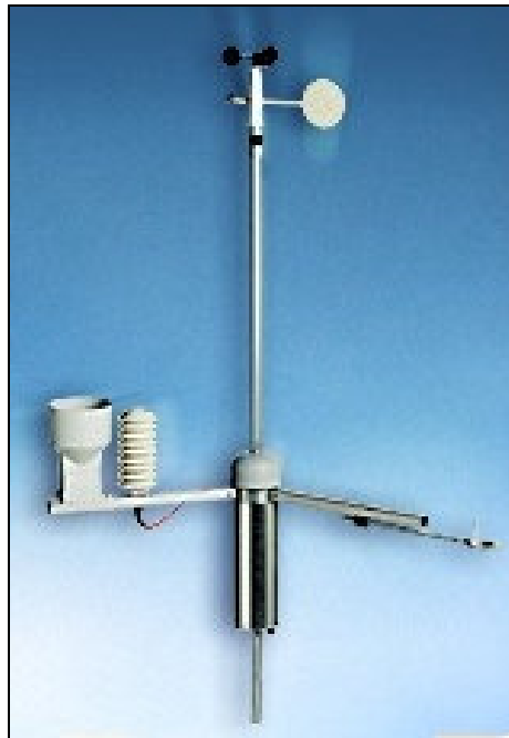
Figura 3.4.15 – Exemplo estação automática
