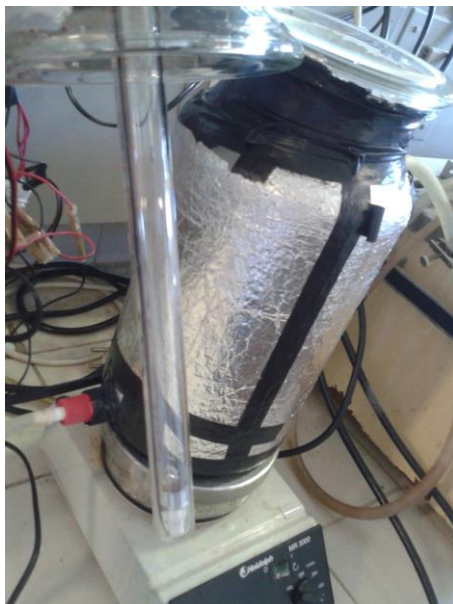
Figura 16. Sistema utilizado nos experimentos de UV e UV/H 2 O 2 com uma lâmpada UV de vapor de Hg (Philips, 8W).
