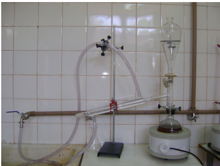
Figura 4 - Aparelho de Destilação por Arraste a Vapor montado.
