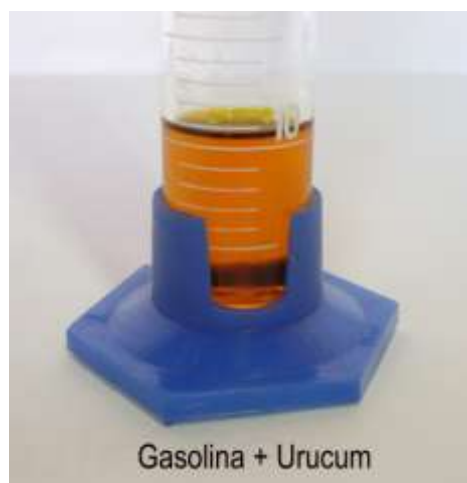
Figura 16: Mistura homogênea composta por gasolina e corante de urucum.
