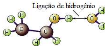
Figura 1: Representação da ligação de hidrogênio entre as moléculas de álcool etílico e água
