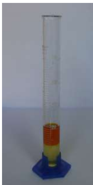
Figura 17: Proveta com o resultado do experimento; na camada superior, coloração alaranjada (fase orgânica - gasolina) e na camada inferior (fase aquosa), coloração amarela.
