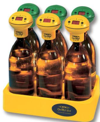
FIGURA 37: Sistema Oxitop® utilizado para as análises de DBO 5 .
