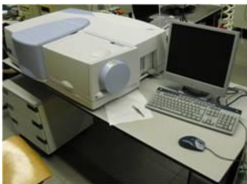
FIGURA 19: Espectrofotometro UV-Vis de reflectância difusa.
