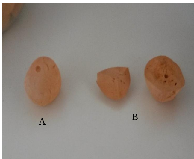
Figura 30: Corpos-de-prova queimados a 850°C, sem adição de Calda Bordalesa (A) e com adição de 50% em massa na argila (B).
