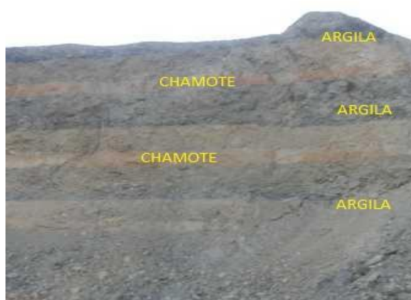
Figura 32: Sazonamento da argila e resíduo chamote.
