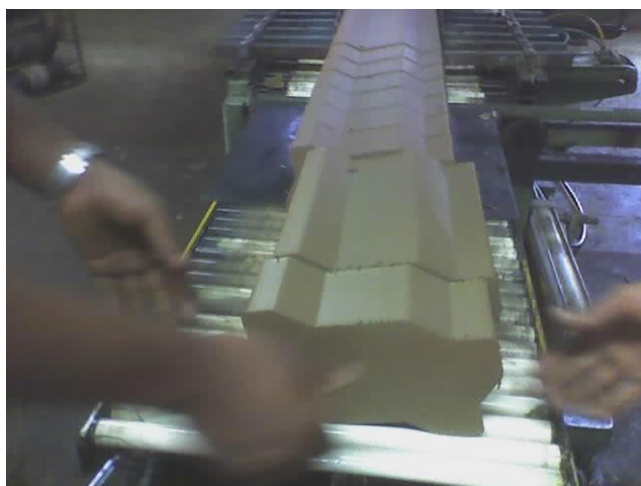
Figura 34: Extrusão de bloco tropeiro na linha de produção.
