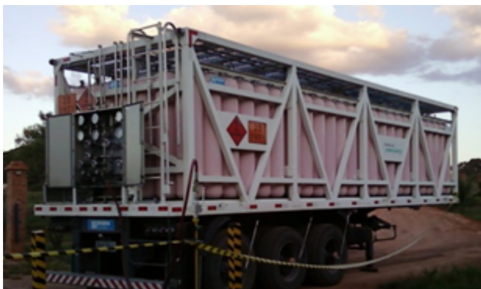
Figura 37 - Caminhão com cilindros de Gás Natural - GNC Foto: Braga, 2014.
