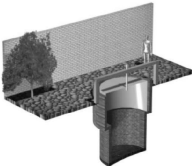
Figura 30 - Biodigestor tipo Batelada [OLIVEIRA, 2009].
