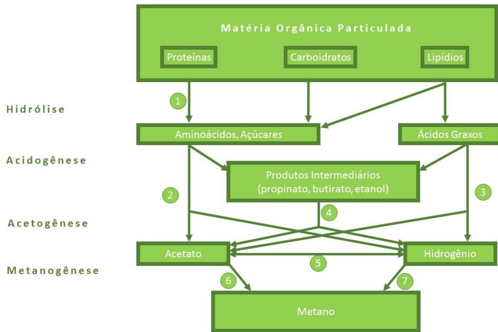
Figura 3 – Etapas do processo de Digestão Anaeróbica (adaptado de Gujer e Zehnder)
