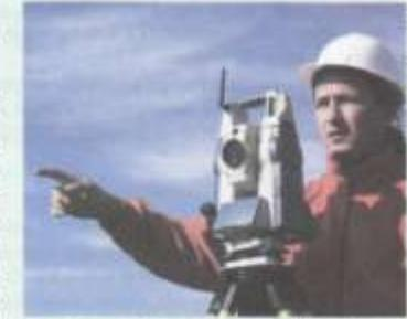
Teodolito moderno, usado para medir ângulos horizontais e verticais em trabalhos topográficos.
