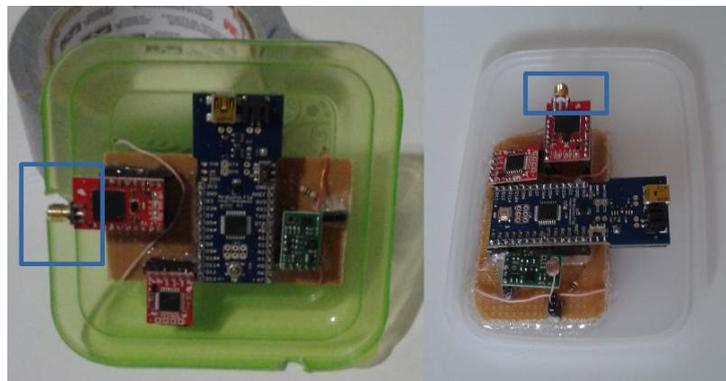
Figura 25 – Duas versões da caixa para encapsulamento do circuito.
