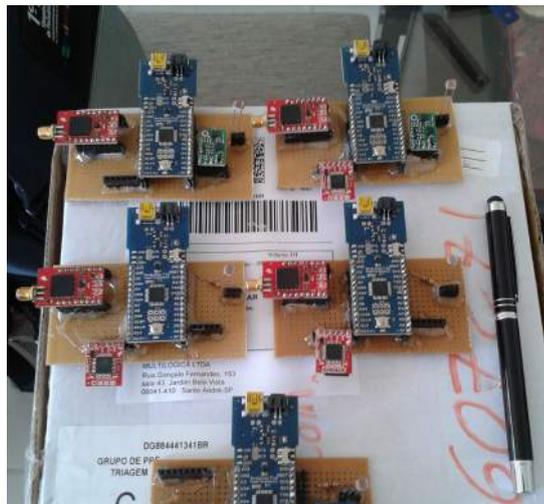
Figura 23 – Placa de circuito com os sensores encaixados.
