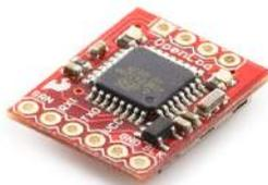
Figura 15 – Módulo OpenLog. Disponível em [Electronics \(2015b\)](#).
