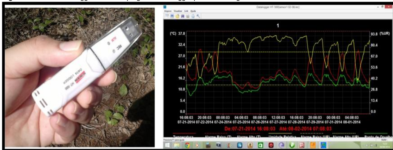
Figura 6: sensor Data Logger HT-500 e programa Datalogger para descarregar os dados.
