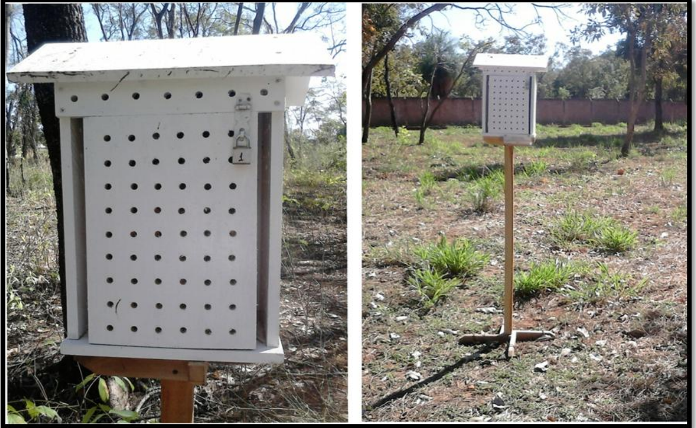
Figura 7: Mini-abrigo utilizado nas medidas de campo conforme o modelo TAR.
