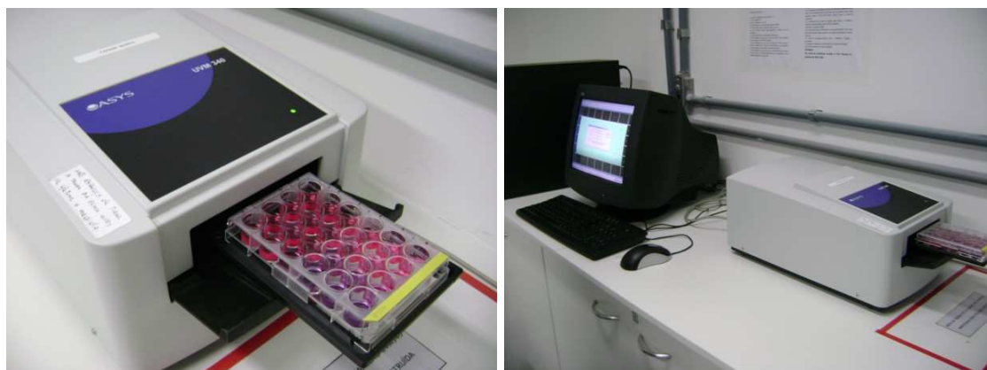
Figura 20 – Monocromador UVM – 340 (Asys) para leitura de absorbância.
