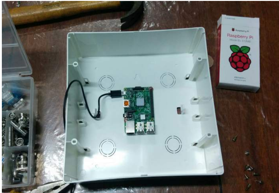
Figura 3.15: Raspberry Pi fixado na caixa de passagem.
