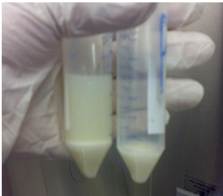
FIGURA 6 – Precipitado de lactose após retirada do sobrenadante. Da esquerda para direita mostrando tubo cônico com leite humano, sobrenadante e precipitado de lactose, seguido do tubo sem o leite humano.
