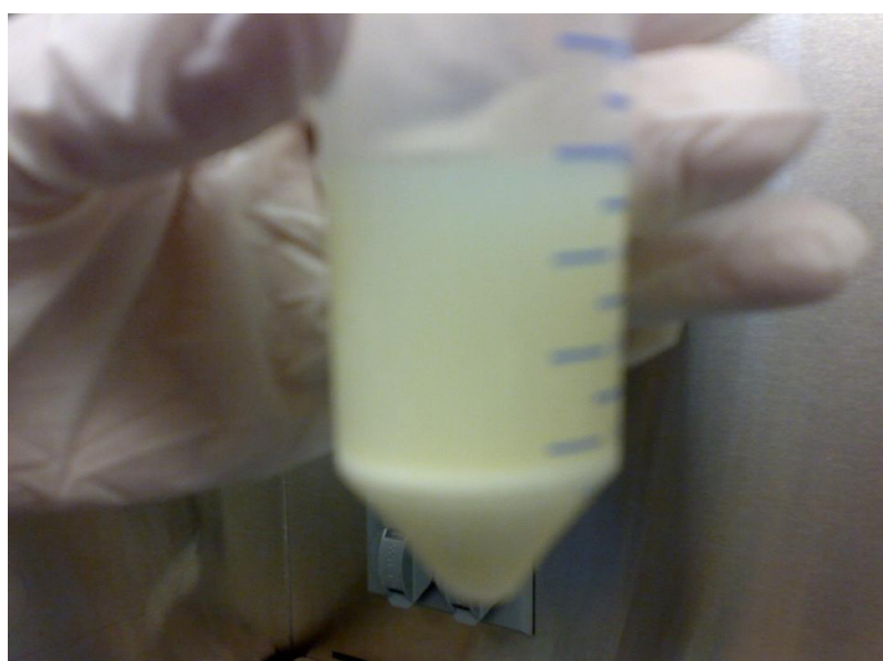
FIGURA 5 – Tubo cônico de plástico contendo leite humano após centrifugação e descongelamento em banho Maria, mostrando o precipitado de lactose evidenciado pela cor mais leitosa.
