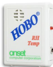
Figura 3.1 - HOBO Temp/RH - H08-003-02.
