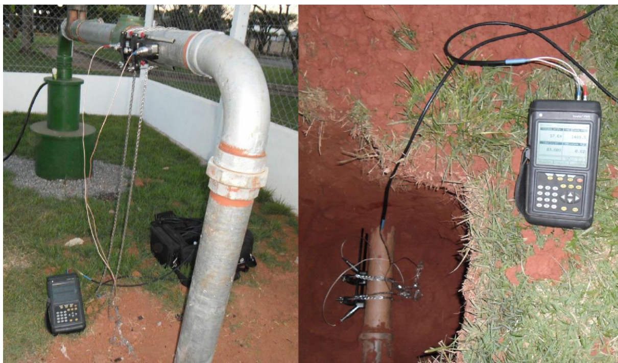
Figura 10 – Medição de vazão com medidor Ultrassônico
