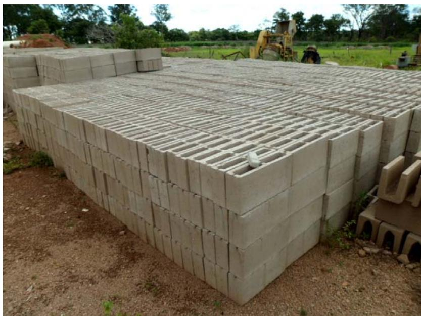
Figura 27. Estocagem dos blocos de RCD. Fonte: Arquivo pessoal
