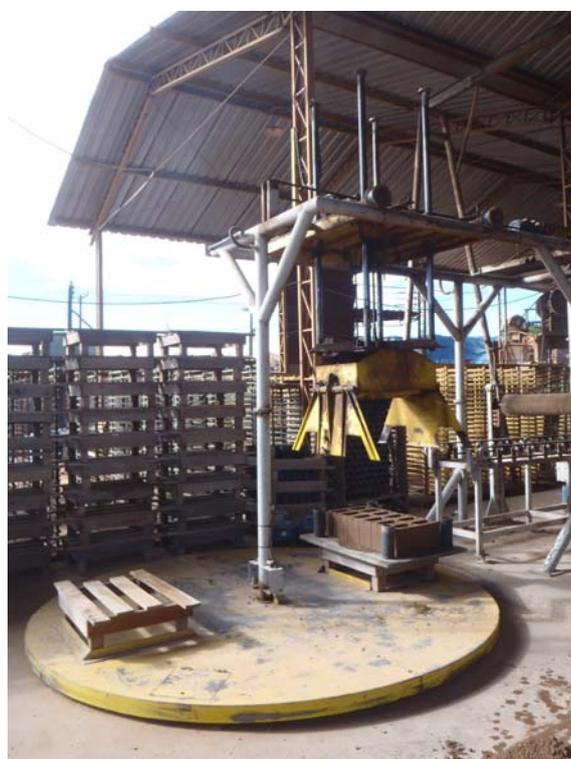
Figura 24. Mesa giratória onde são colocados os *pallets* de blocos. Fonte: Arquivo pessoal
