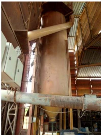
Figura 20 - Silo utilizado para armazenamento da poeira gerada durante o processo de britagem do RCD.
