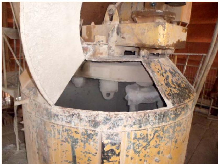
Figura 21. Equipamento utilizado para realizar a mistura da massa do bloco.
