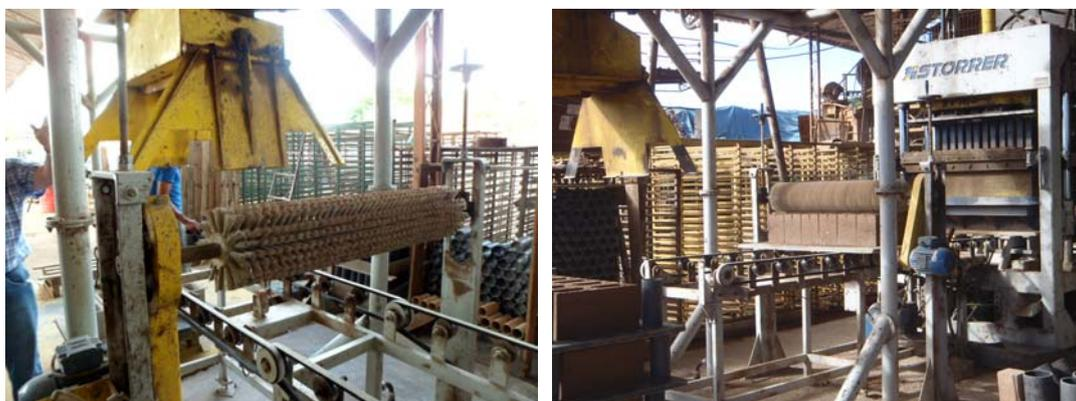
Figura 23. Equipamento responsável pela textura dos blocos. Fonte: Arquivo pessoal
