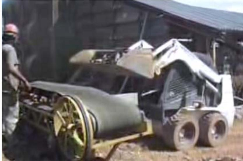
Figura 14. Correia transportadora onde são despejados os resíduos para o início do processo produtivo.
