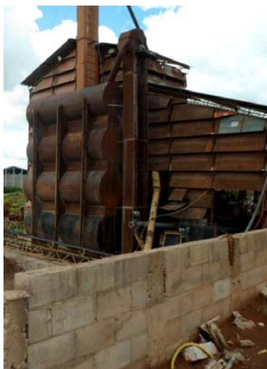
Figura 19. Silo utilizado para armazenamento do RCD reciclado.
