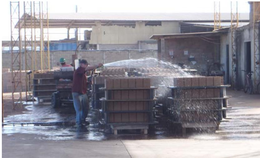
Figura 26. Processo de lavagem dos blocos.
