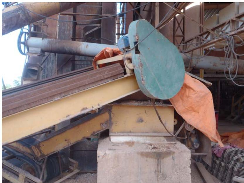
Figura 17 – Peneiramento para definição da composição granulométrica. Fonte: Arquivo pessoal
