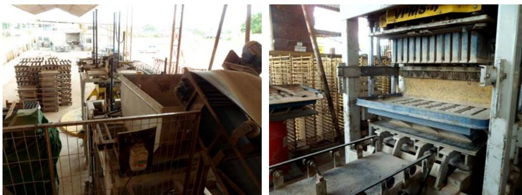
Figura 22. (a) Correias transportadoras que conduzem a massa para vibro prensa. (b) vibro prensa automática. Fonte: Arquivo pessoal
