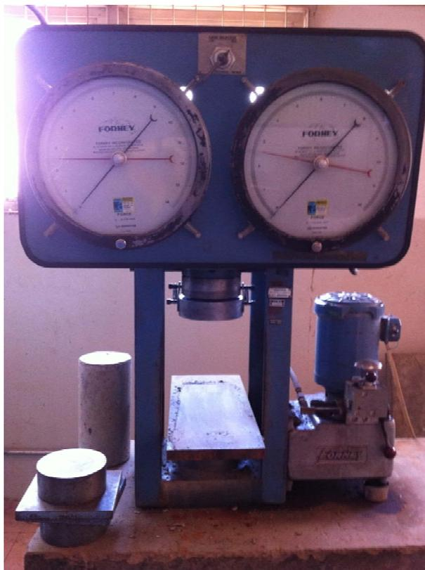
Figura 8. Prensa utilizada no ensaio de resistência à compressão
