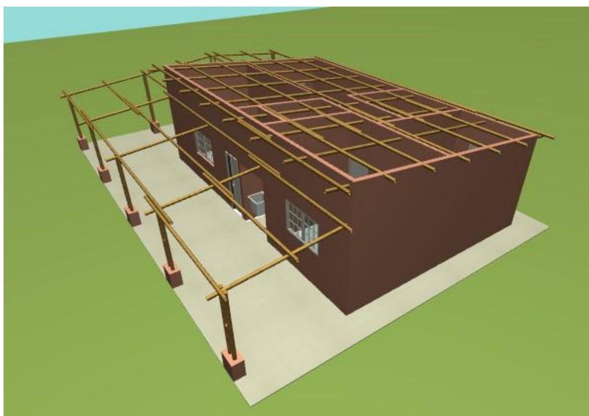
Perspectiva posterior - estrutura de cobertura S/ escala
