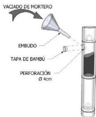
Fig. 33 – Enchimento do colmo com argamassa (utiliza-se funil ou objeto adaptado para tal fim) Fonte: Norma Técnica Peruana E100
