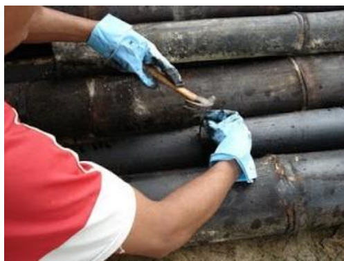
Fig. 80 - Fechamento dos furos Fonte: http://cursodebambu.blogspot.com.br/p/tratamento-de-bambu.html ( acessado em 20/04/2014)
