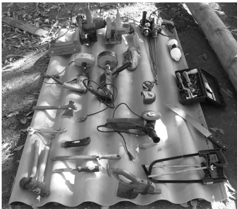
Fig. 93 - Ferramentas para montagem da estrutura de cobertura
