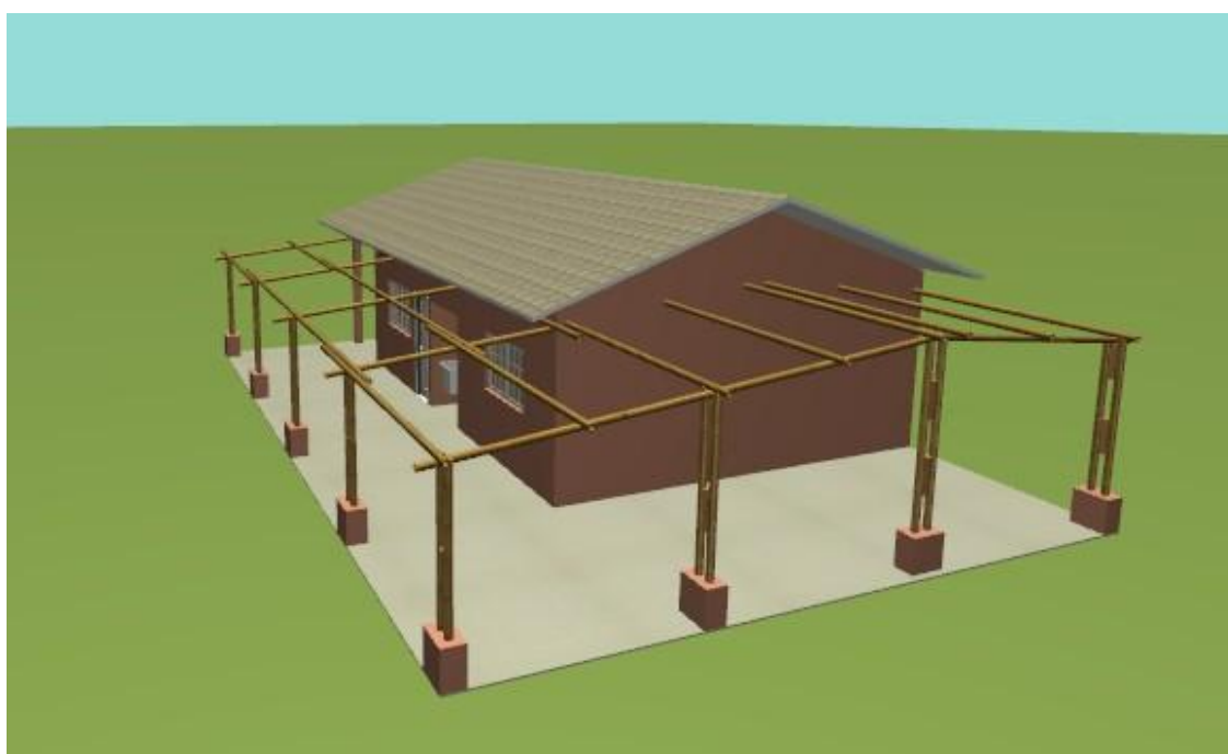
Perspectiva - estrutura de cobertura S/ escala
