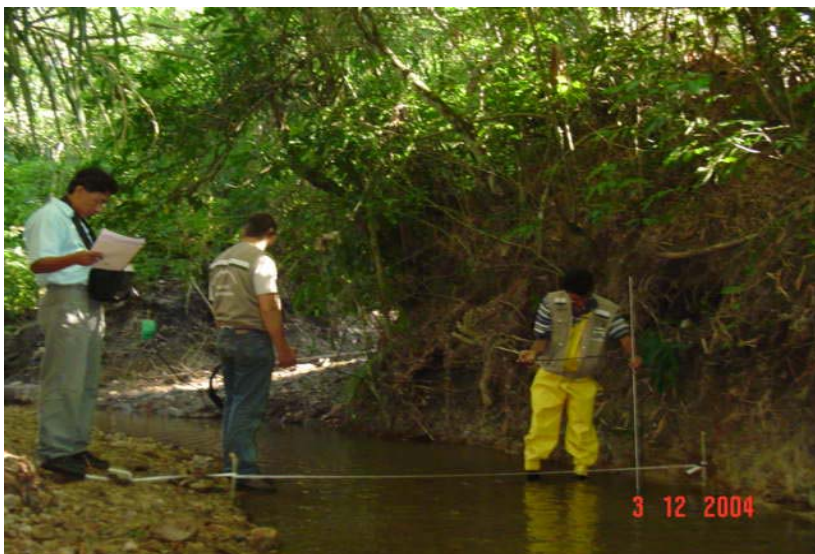
Figura 2.6 – Medição da descarga líquida no córrego Bonito no ponto P5.
