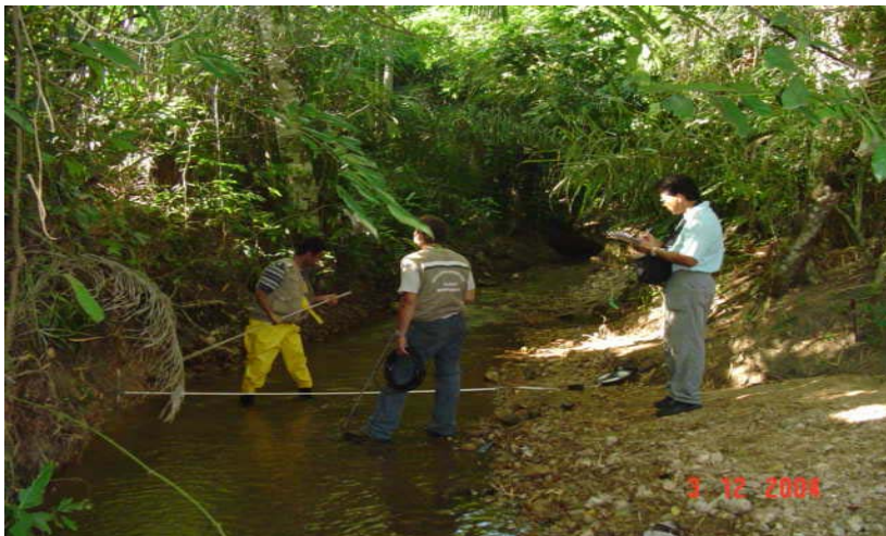
Figura 2.5 – Medição da descarga líquida no córrego Bonito no ponto P3.
