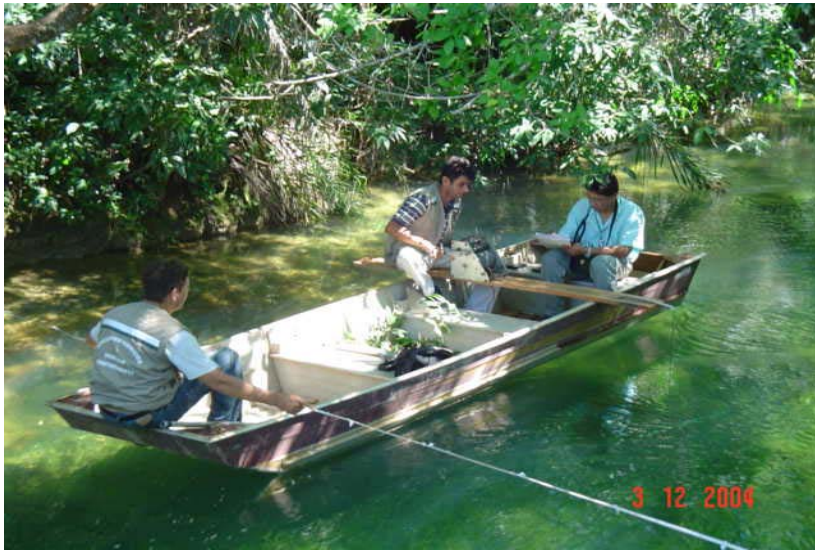
Figura 2.4 – Medição da descarga líquida no rio Formoso no ponto P1.
