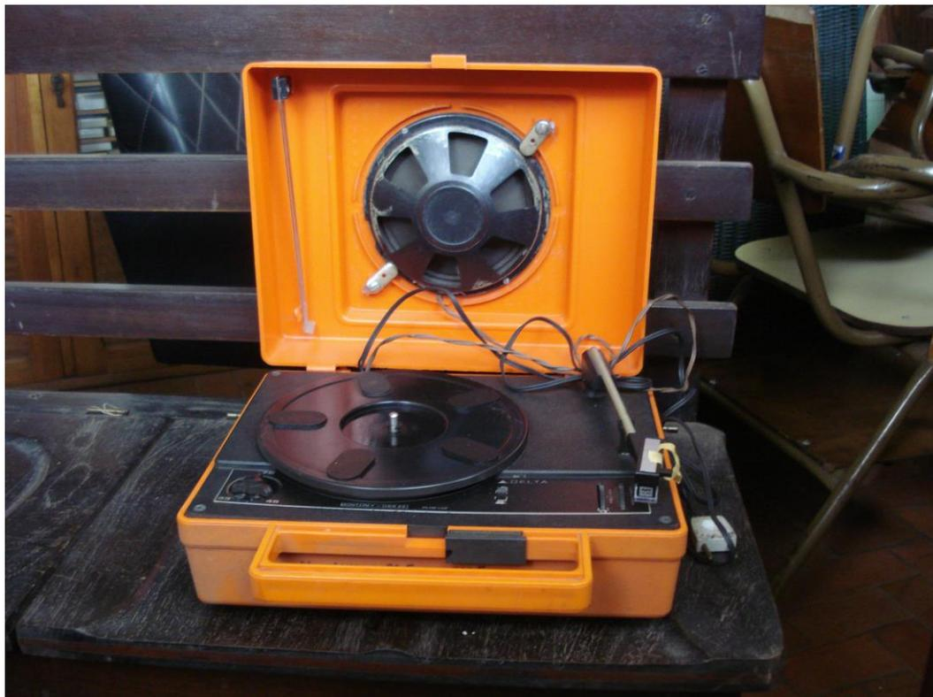
Figura 26: Toca-discos de vinil portátil (DELTA), 33, 45 e 78 rpm
