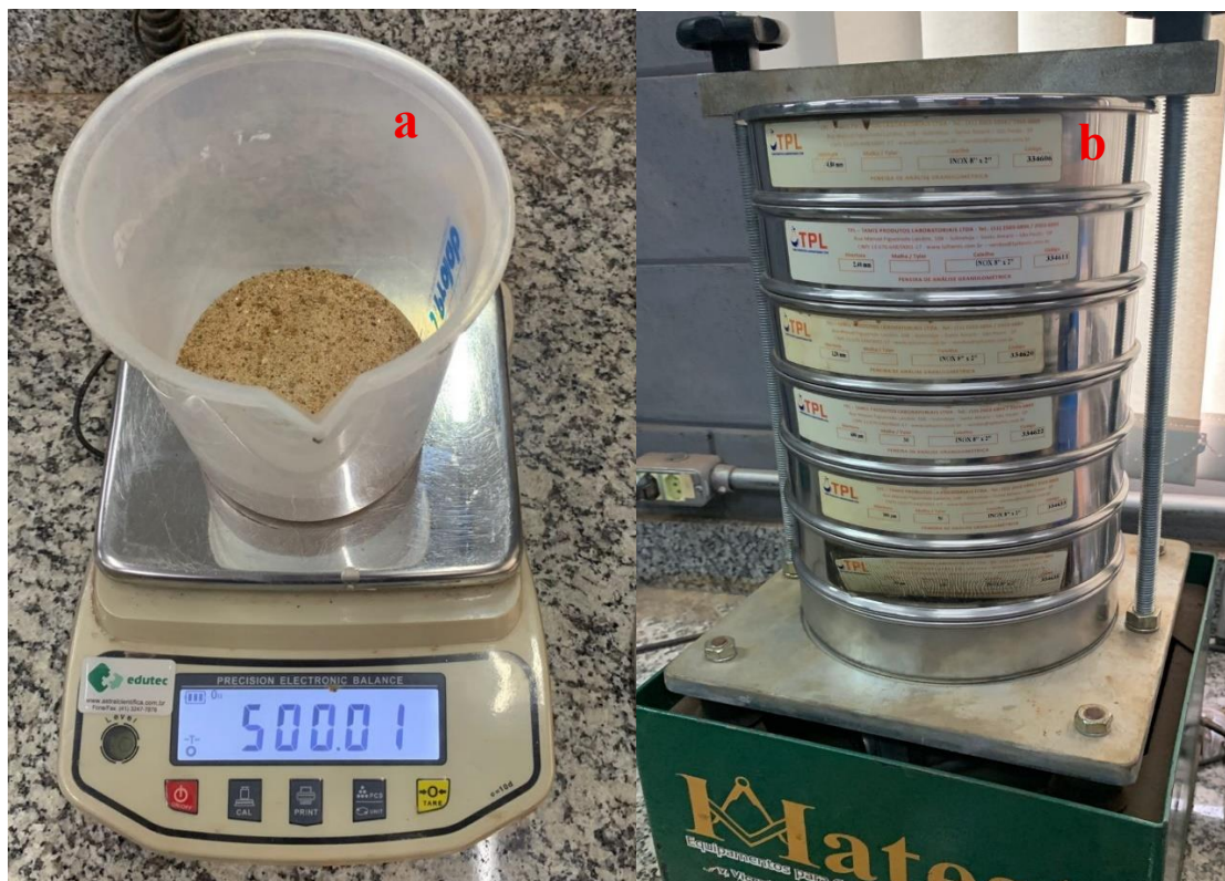
Figura 6 – a) Amostra de areia e b) Peneirador de bancada utilizado para a realização dos ensaios
