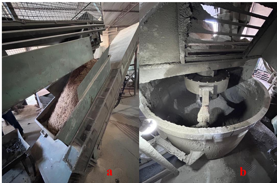
Figura 7 – a-) Esteira de entrada com areia fina e b-) Misturador planetário
