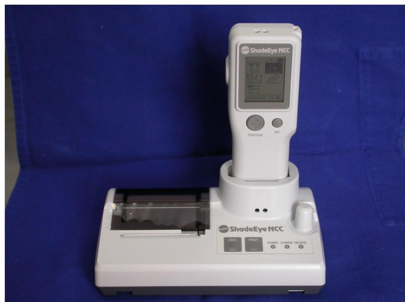
Figura 4.5 – Espectrofotômetro (Shade Eye NCC®, Tóquio, Japão)
