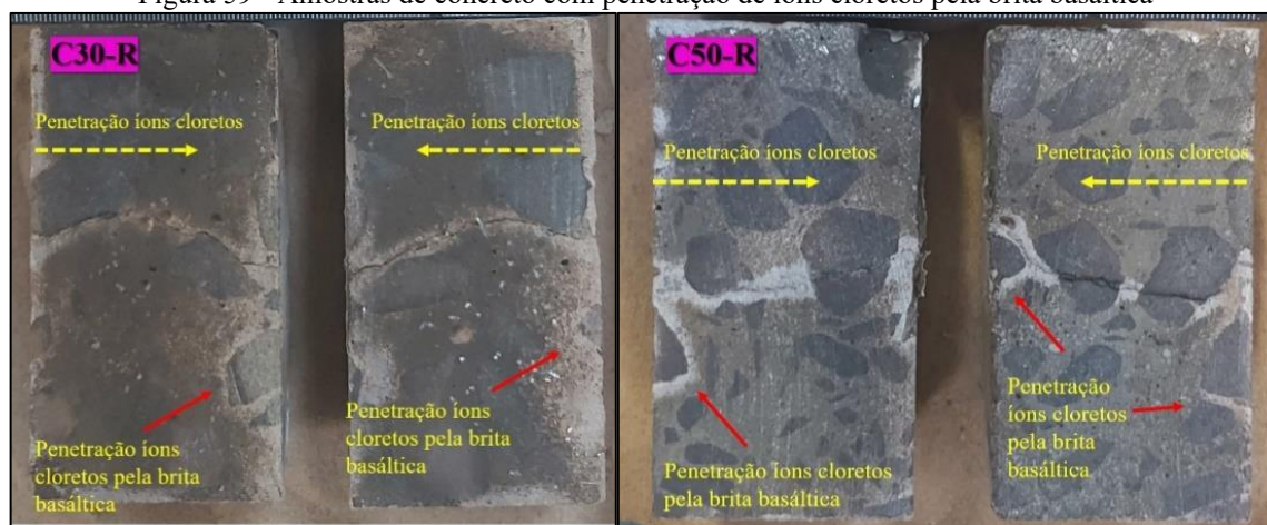
Figura 59 - Amostras de concreto com penetração de íons cloretos pela brita basáltica
