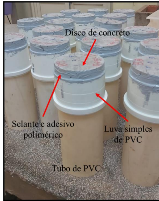
Figura 19 - Aparato para os ensaios de permeabilidade de água e penetração de cloretos
