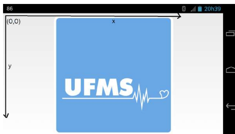
Figura 3.13: Sistema de coordenadas utilizado na tela de aplicativos Android .
