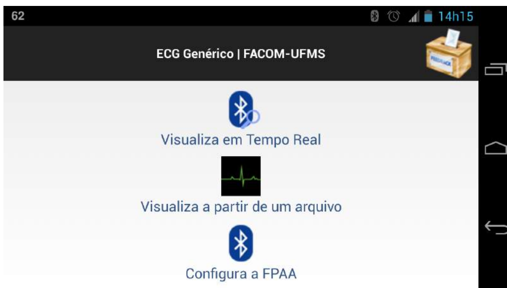
Figura 3.9: Tela inicial do aplicativo Android. Pode-se observar que o usuário deve selecionar entre visualizar os sinais de ECC em tempo real ou a partir de um arquivo, ou configurar a FPA .
