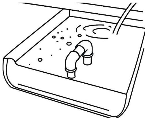
Figura 12. Esquema representativo do sifão em “U” invertido
