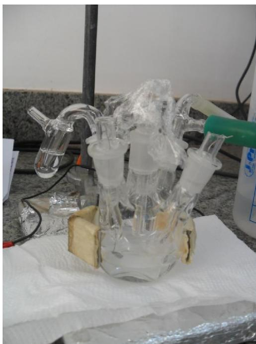
**Figura 2. Célula eletroquímica.**
