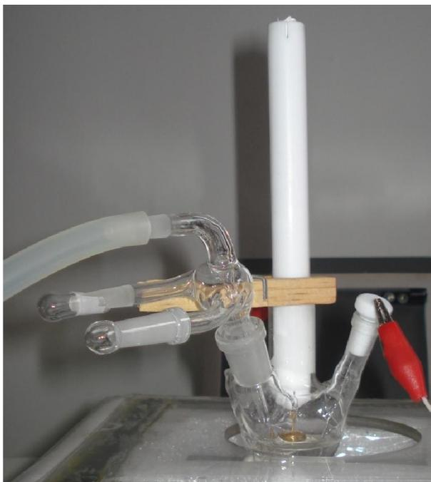
**Figura 6. Célula espectroeletroquímica de três eletrodos usada nos experimentos de espectroscopia de FTIR *in situ*.**
