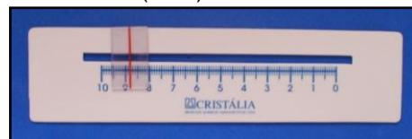
Figura 15 - Algômetro de pressão (Wagner instruments USA)
