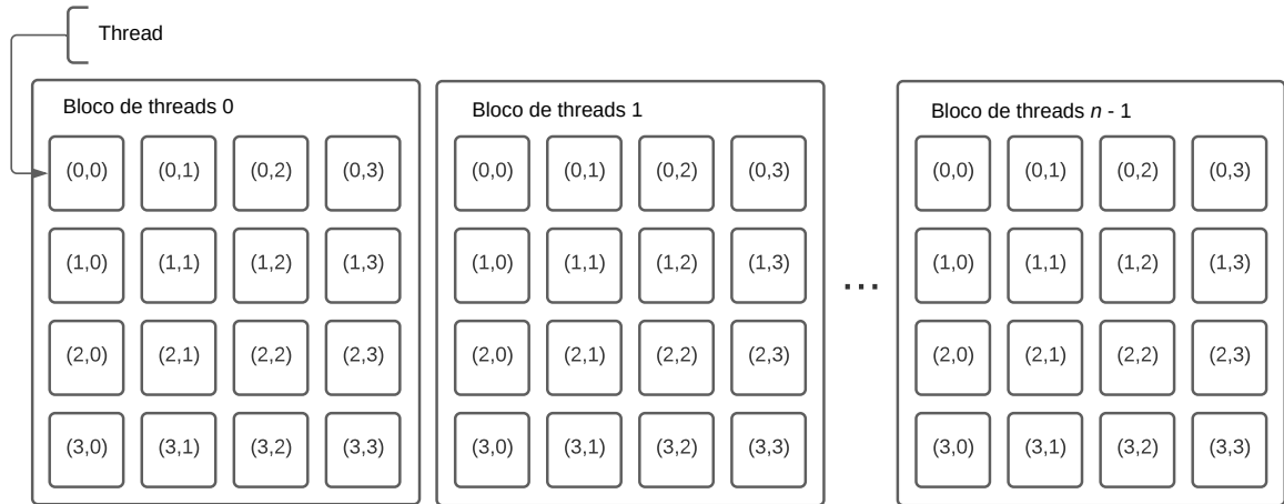
Figura 3.2: Modelo de programação CUDA, no qual as threads estão agrupadas em blocos de threads que por sua vez foram uma grade de threads . Este é o modelo lógico, no qual cada thread é identificada por uma coordenada na grade e uma coordenada num bloco e não representa o que ocorre de fato no hardware .
