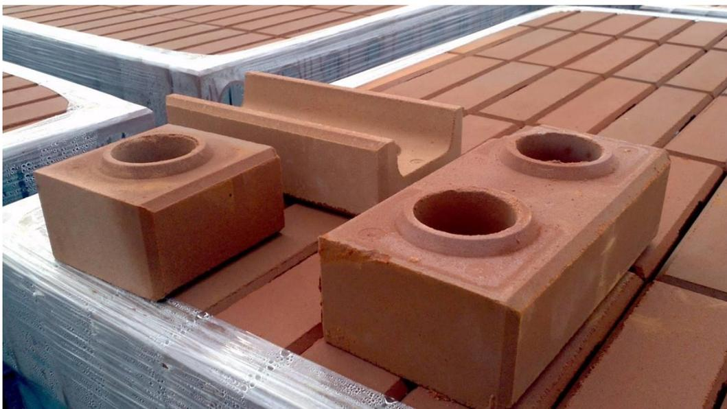
O solo-cimento é um compósito, material resultante da mistura homogênea em proporções apropriadas e endurecidas de solo, cimento e água. A estabilização deste material, que é um processo físico-químico, está relacionada ao aumento de resistência mecânica e da durabilidade do composto. O estabilizador químico mais conhecido e utilizado neste tipo de composto é o cimento, cujas propriedades na estabilização de solos são consagradas a mais de 40 anos na construção de estradas. [35]
