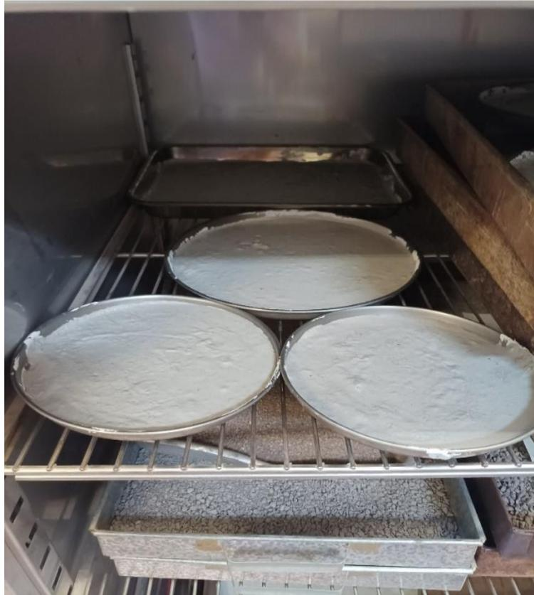
Após o processo de desidratação, as amostras se apresentam no formato de torrões. Com o objetivo de destorroar e diminuir o tamanho dos grãos, o PVS foi levado ao almofariz de cerâmica para maceração do LMCC – Laboratório de Materiais de Construção Civil, pelo tempo necessário até chegar em uma textura capaz de passar pela peneira 45 Mesh, conforme figura 18.
