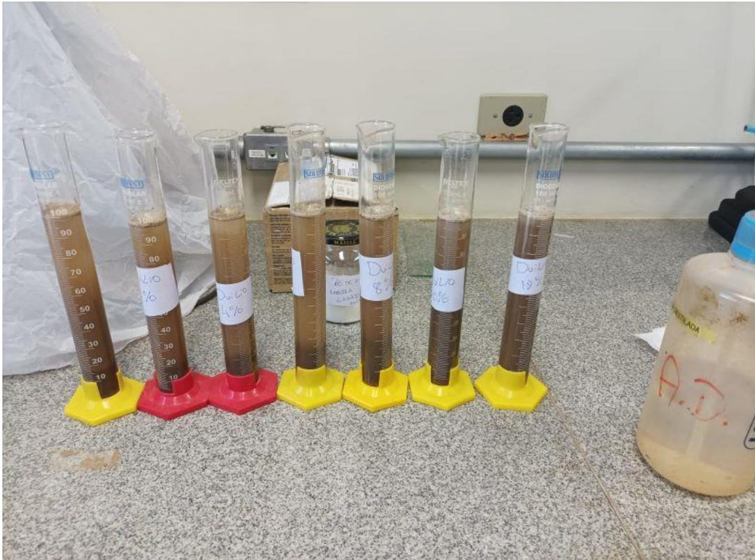
Para a realização dos ensaios mecânicos (módulo de resiliência, resistência à tração por compressão diametral e resistência à compressão simples) na mistura solo + cimento (padrão) e solo + pó de vidro, foi utilizado as porcentagens de 2,5%, 3,5%, 5% e 7% como referência para análise de cimento e de pó de vidro no solo, sendo as misturas conforme descrito:
