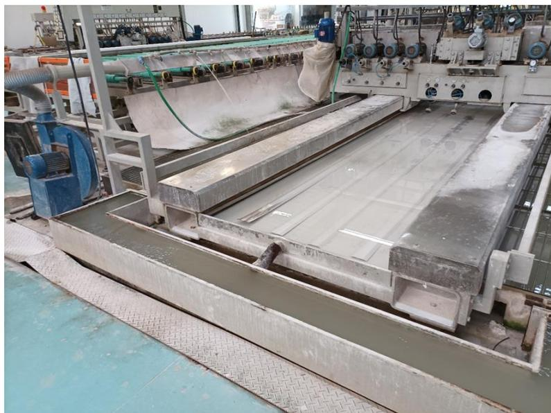
Após, a contenção do pó de vidro pela água, faz-se necessário tratar esta água separando os grandes resíduos do pó de vidro, que por fim é destinada a tonéis metálicos para ocorrer o processo de decantação – separação da mistura heterogêneas do tipo líquido-sólido.
