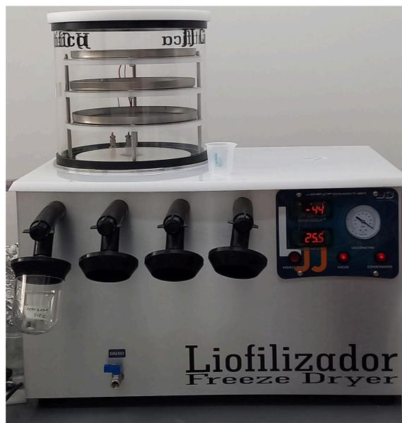
Figura 12- Equipamento liofilizador de bancada, modelo Linha LJJ, fabricante JJ Científica.
