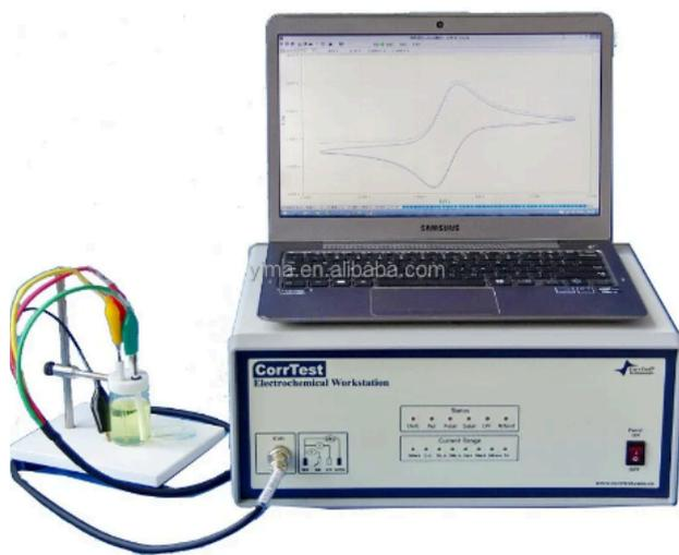
Figura 20 - Equipamento utilizado para caracterização eletroquímica das amostras.
