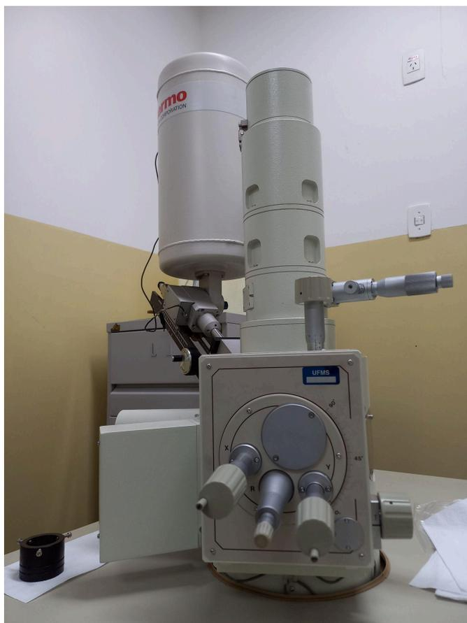
Figura 19- Equipamento Microscópio Eletrônico de Varredura para caracterização morfológica.
