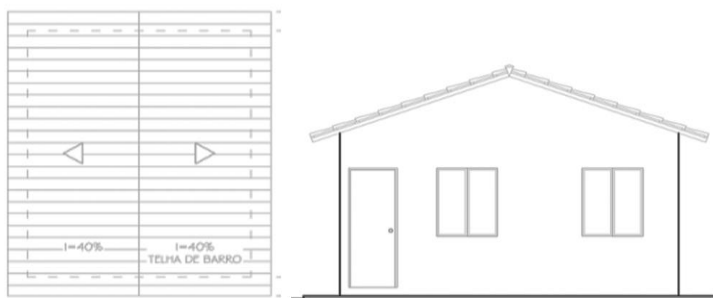
PLANTA DE COBERTURA FACHADA FRONTAL
