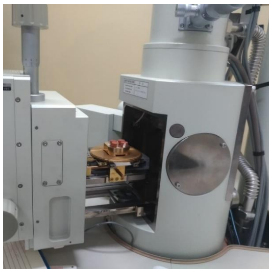
Figura 18 – Microscópio eletrônico de varredura JEOL JSM6380-LV
