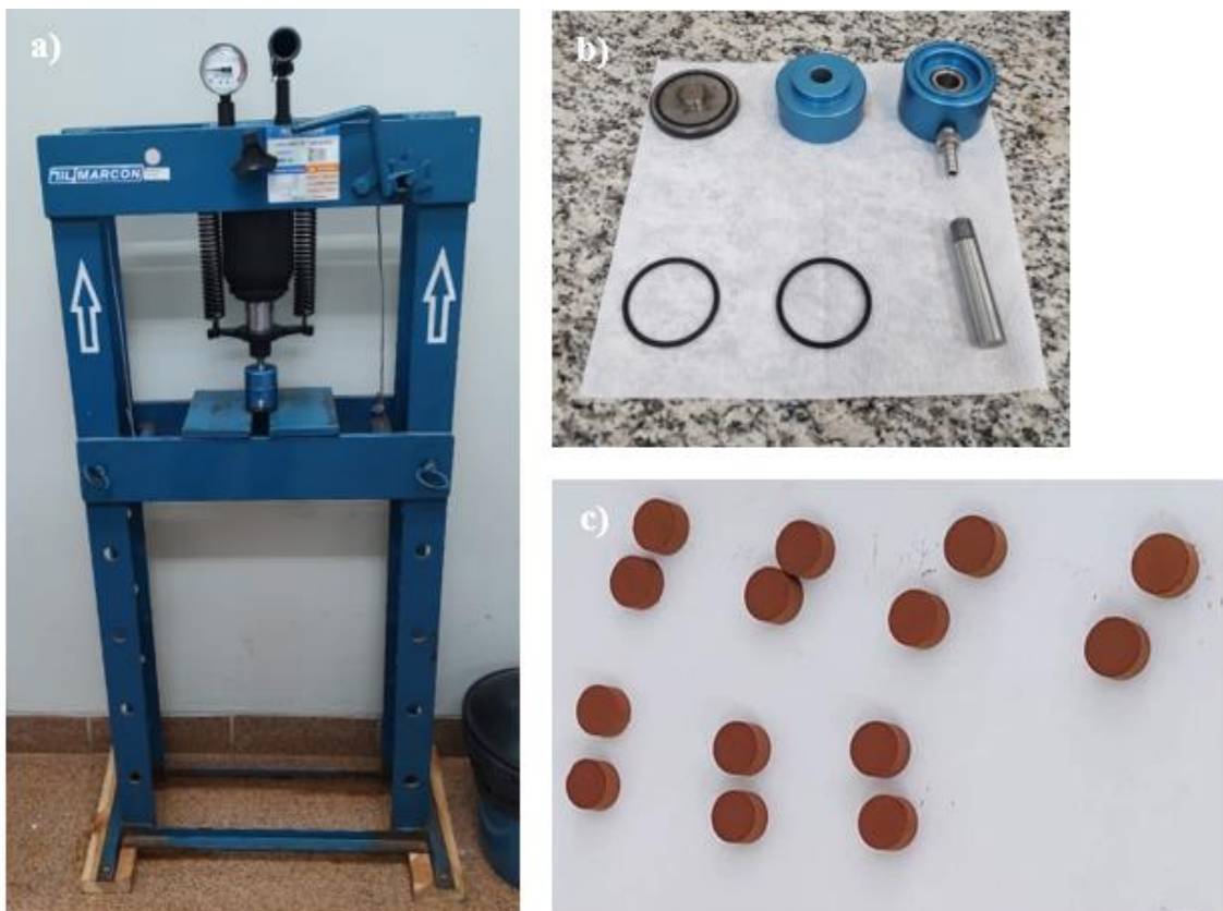
Figura 13 – (a) Prensa Hidráulica para 15 toneladas - MARCON-MPH-15, (b) pastilhador e (c) pastilhas de laterita
