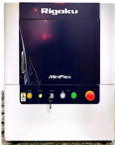
Figura 19 – Difratorômetro de raios x Rigaku MiniFlex
