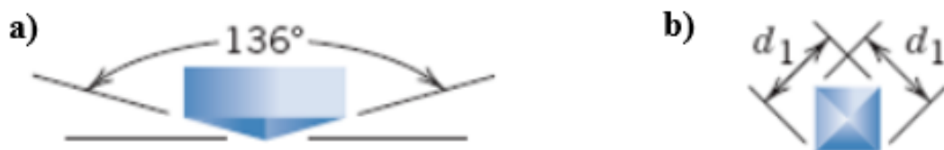
Figura 21 – Forma da impressão no ensaio de microdureza Vickers [34], (a) vista lateral do penetrador (b) vista superior da impressão
