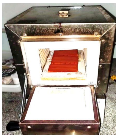
Figura 26 – Forno mufla EDG 1800 com os corpos de prova de laterita
