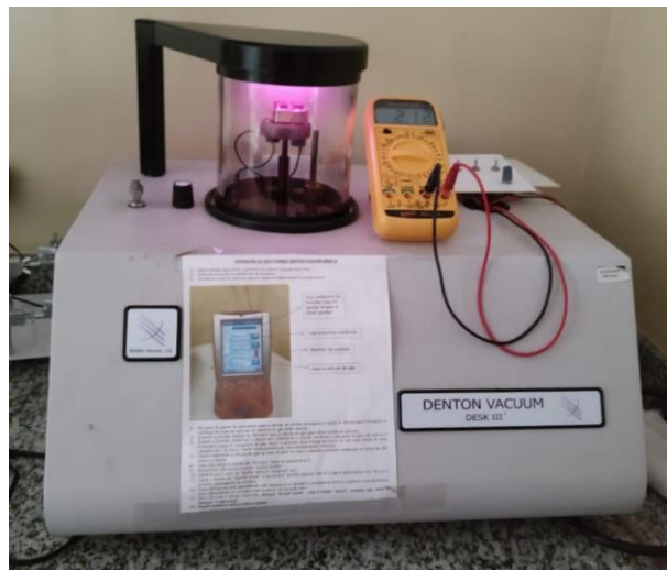
Figura 17 – Bench Coater para Microscopia Eletrônica e Preparação de Amostras Denton Vacuum Desk III
