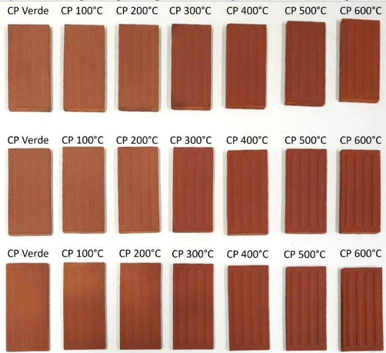
Figura 47 –Corpos de prova após a sinterização em diferentes temperaturas
