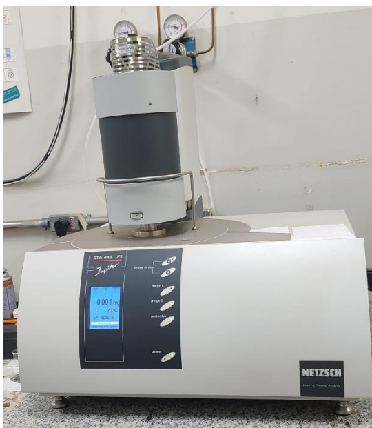
Figura 16 – Analisador térmico simultâneo STA 449 F3 Jupiter
