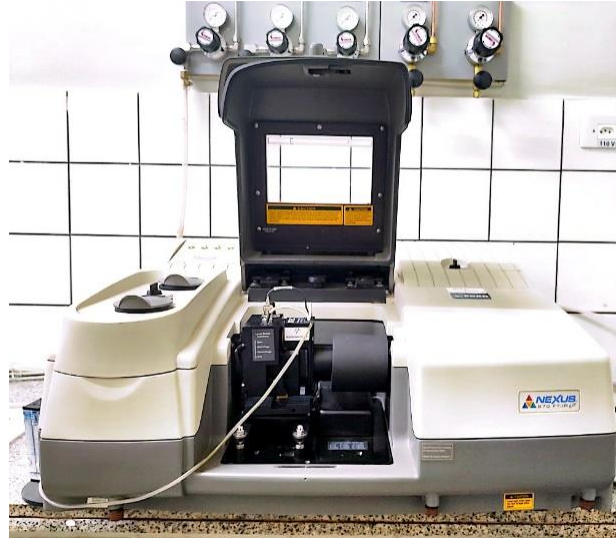
Figura 20 – Espectrofotômetro com transformada de Fourier Thermo Nicolet Nexus
