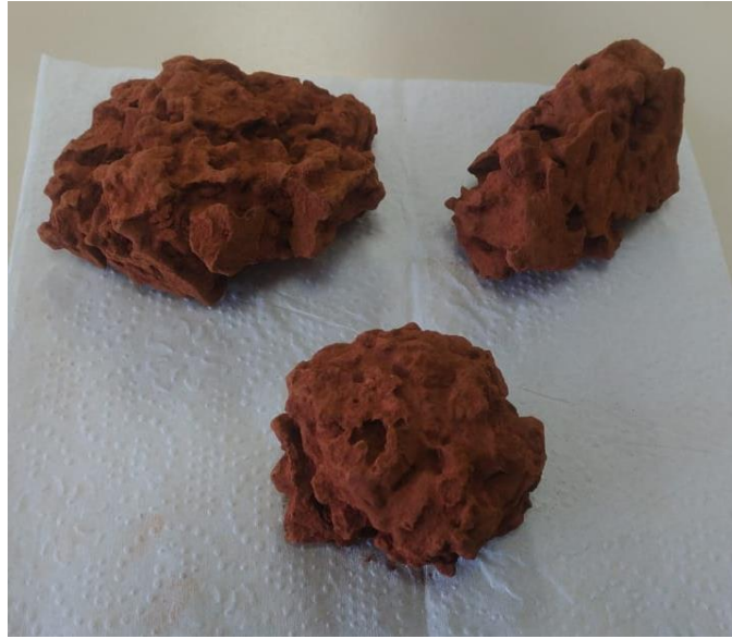
Figura 11 – Torrões de laterita
