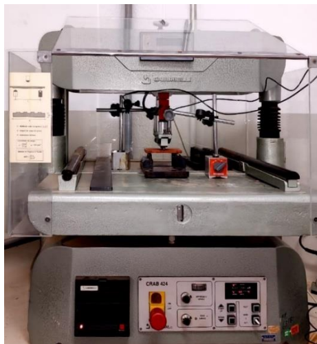
Figura 29 – Flexômetro modelo Gabbrielli CRAB 424 com um corpo de prova de laterita
