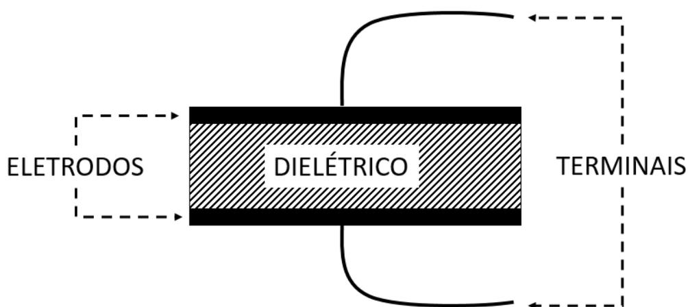
Figura 3 - Elementos de um capacitor de placas paralelas. Imagem do autor.
