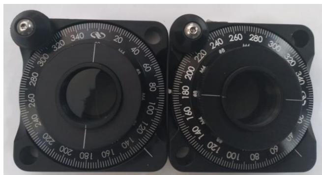
Figura 2. Polarizadores de excitação (esquerda) e emissão (direta) sobre uma base giratória Newport (RSP-1T).
