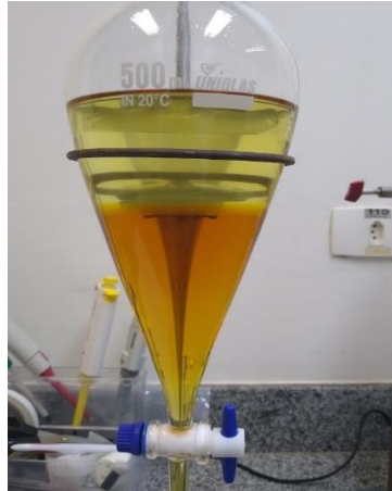
Figura 1. Funil de decantação apresentando as fases originadas do processo de produção do biodiesel. O biodiesel corresponde a fase superior e os resíduos a fase inferior.
