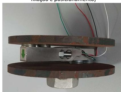
Calços para flexão do sensor, na imposição de um esforço na superfície do conjunto de medição
