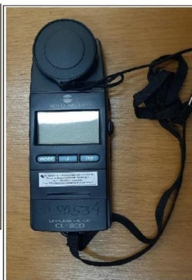
**Foto 2:** Luxímetro com Medidor de Chroma CL-200 marca Konica Minolta.
