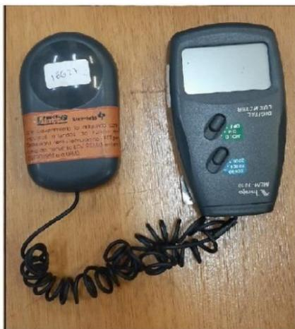
**Foto 1:** Luxímetro digital modelo MLM-1010 fabricado pela Minipa Industria e Comércio Ltda.
