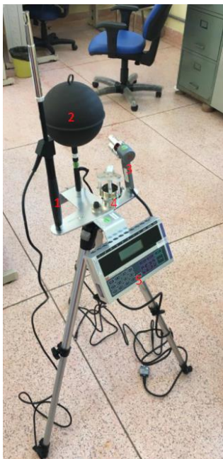
Figura 18. Componentes do confortímetro BABUC/A: 1. Anemômetro BSV 101 2. Termômetro de globo BST 131 3. BSU 102 - termômetro de bulbo seco e úmido 4. termômetro de bulbo úmido natural 5 - Processador.
