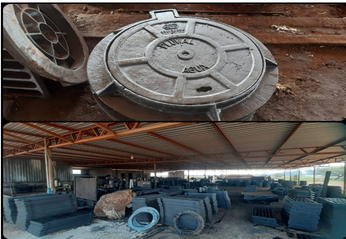
Figura 23 - Produção de Tampas de Esgoto.
