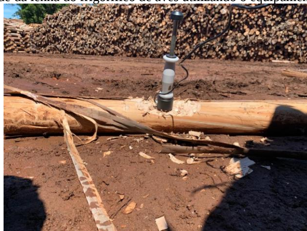
Figura 27 - Medidor de umidade da lenha do frigorífico de aves utilizando o equipamento DL2000 Digisystem.
