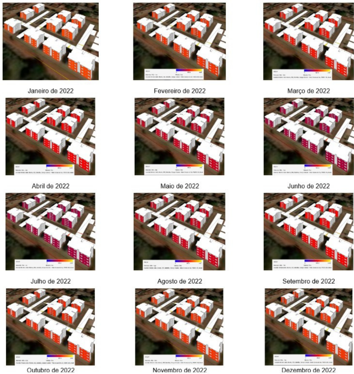
Figura A.2. Projeção de Simulação dos picos máximos de Irradiação Solar em fachadas LESTE
