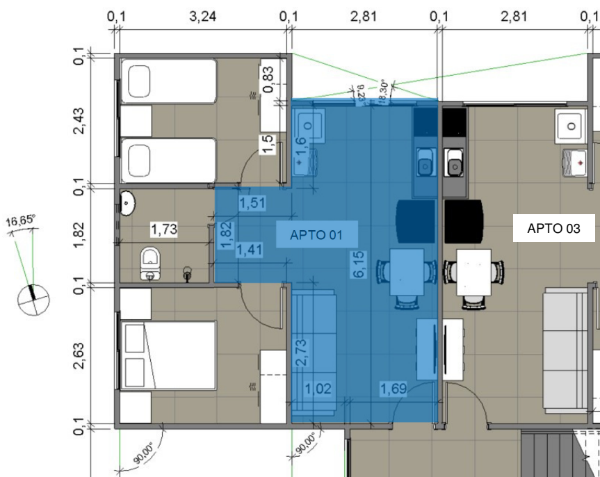
Figura 33. Ambiente de Permanência Prolongada APP: Sala
