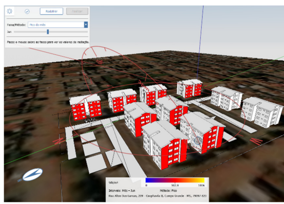
Fachadas Face Oeste
