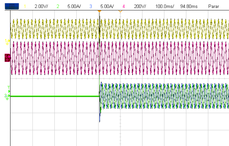
Figura 64. Inicializa  o do sistema para cargas resistivas com 600 W. Escalas - Tempo: 100 ms/div; Em amarelo a tens  o de refer  ncia do PLL: 2 V/div; Em azul corrente da fase A: 5 A/div; Em verde corrente da fase B: 5 A/div; Em rosa a tens  o da fase A da rede el  trica: 200 V/div.
