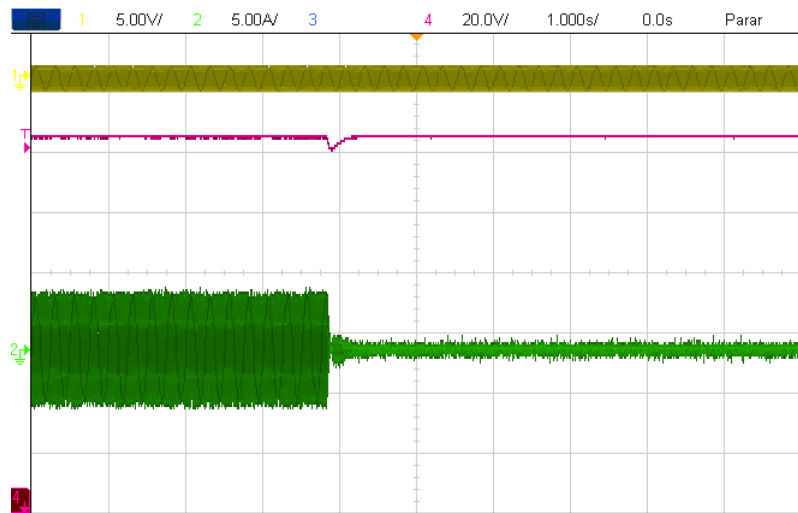
Figura 80. Formas de onda para desligamento do sistema integrado entre conversor de baterias e Grid-Tied com pot  ncia de 1,3 KW. Escalas - Tempo: 1 s/div; Em amarelo a tens  o de refer  ncia do PLL 5 V/div; Em verde corrente da fase A: 5 A/div; Em rosa a tens  o do barramento CC: 100 V/div.
