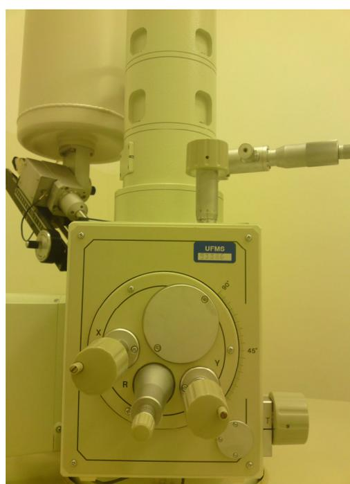
Figura 10 – Coluna ótico-eletrônica, detector e câmara de amostras.
