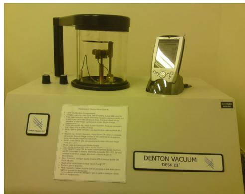
Figura 8 – Equipamento utilizado para deposição metálica sobre as amostras.
