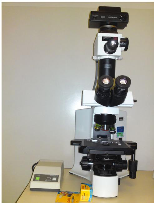
Figura 6 - microscópio de luz acoplado à câmera fotográfica (aberta).
