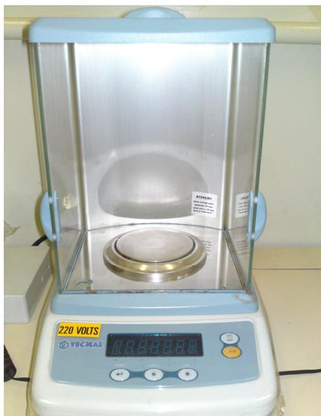
Figura 2 – balança eletrônica de precisão *Tecnal, Mark 210 A*.
