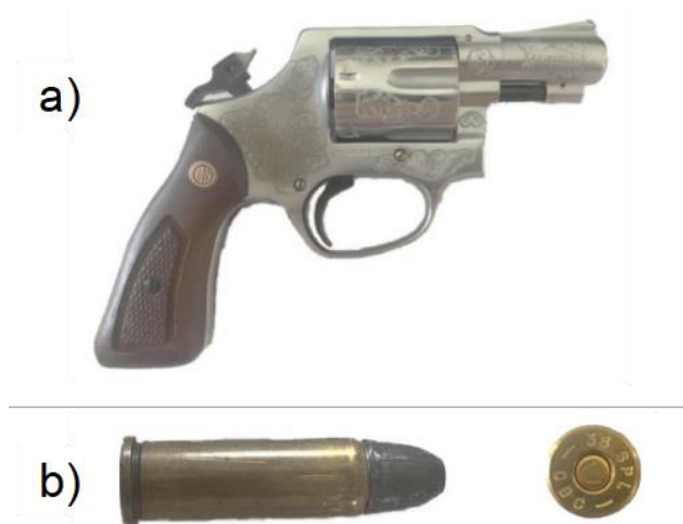
Figura 1 - a) revólver calibre .38 SPL Amadeo Rossi S.A. utilizado na etapa de disparos e b) perfil e inscrições da base da munição .38 SPL.
