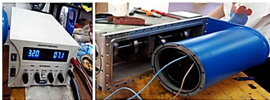
Figura 27. Motor Stirling e fonte DC conectado ao motor gerador
