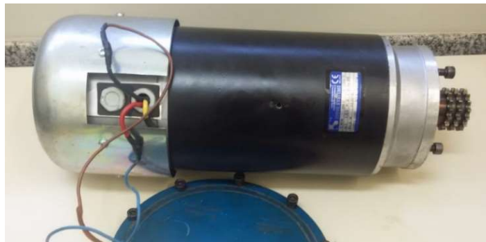
Figura 12. Moto gerador DC
