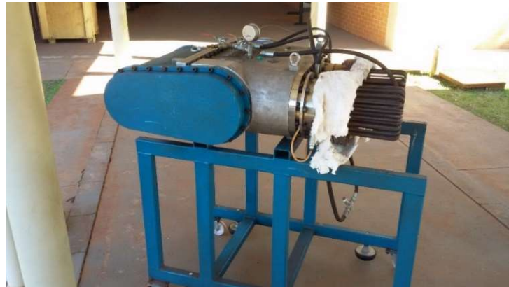
Figura 11. Protótipo Motor Stirling modelo GE03-0014
