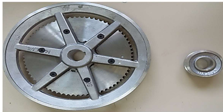
Figura 42. Polia canal B do motor e gerador
