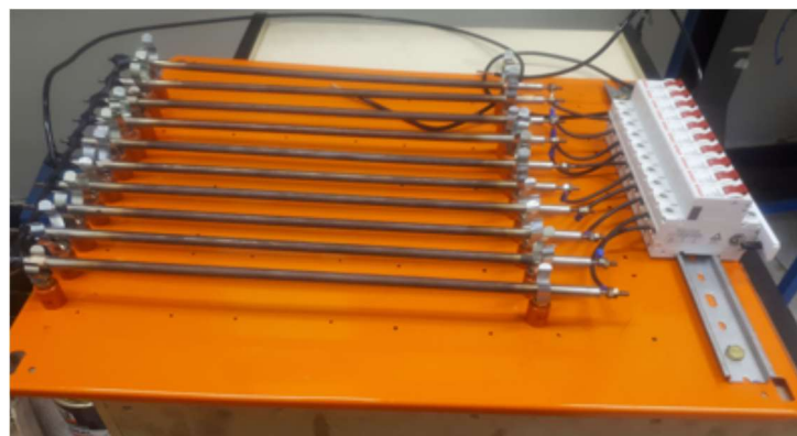
Figura 57. Placa com arranjo de resistências de 47 W
