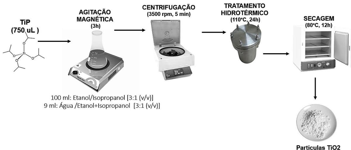
**Figura 10 - Esquema ilustrativo da preparação de partículas TiO<sub>2</sub> e tratamento hidrotérmico.**
